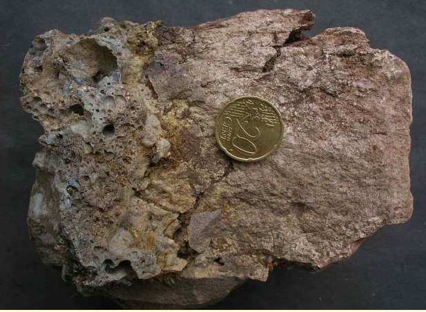
Glaskruste auf einem Stein aus der Wandung eines Kalkbrennofens.
